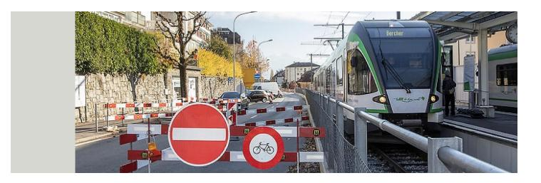
La ligne de chemin de fer Lausanne-Échallens-Bercher (LEB), bien qu'essentiellement en site propre, possède une zone commune au trafic routier et ferroviaire. Cette zone, où la circulation ferroviaire se fait à simple voie et en régime «tram» (marche à vue), se situe sur l'avenue d'Échallens, entre la sortie du tunnel de Chauderon et le carrefour de Montétan.
